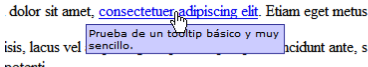
Figura 8.9. Centrando el tooltip respecto de la posición del ratón
